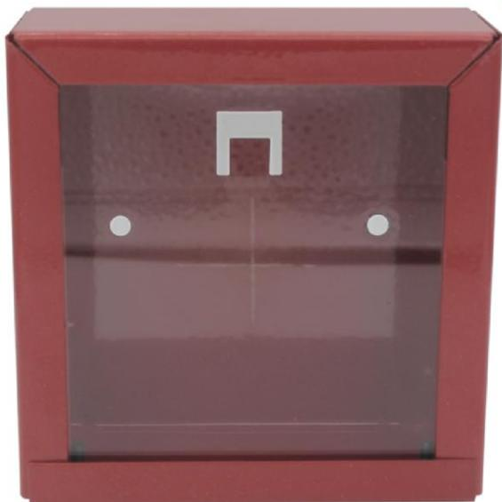
Este elemento se emplea para aquellos casos donde la cerradura que se utiliza es de seguridad y que, ante un corte de energía, hace que la puerta quede cerrada. En estos casos, por normas de seguridad, es recomendable colocar esta caja de emergencia en el interior del recinto. La caja es metálica, con frente de vidrio, que se podrá romper, en caso de emergencia, para extraer la llave y así abrir la puerta manualmente.
